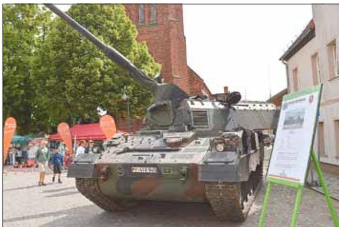
Das Heer trumpfte mit verschiedenem Großgerät auf, darunter auch die Panzerhaubitze 2000. Dieses gepanzerte Artilleriegeschütz bringt über 55 Tonnen Gefechtsgewicht auf die Waage und wird von einem 1.000 PS starken Motor angetrieben. Die Reichweite der 155-Millimeter-Haubitzen kann unter bestimmten Bedingungen jenseits von 50 Kilometern liegen.
